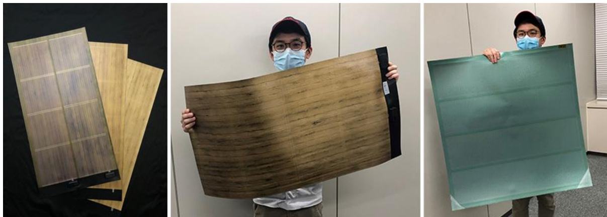
加飾フィルムを F-WAVE が量産する軽量フレキシブル太陽電池に実装した状態 木目調加飾フィルム（左）と単色フィルム（右）を貼り付けた加飾太陽電池
