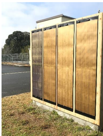
木目調加飾フィルム（左）と単色加飾フィルムを実装したフレキシブル太陽電池の実証実験風景
