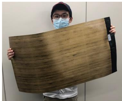
加飾フィルムを F-WAVE が量産する軽量フレキシブル太陽電池に実装した状態 木目調加飾フィルム（左）と単色フィルム（右）を貼り付けた加飾太陽電池
