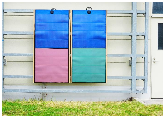
木目調加飾フィルム（左）と単色加飾フィルムを実装したフレキシブル太陽電池の実証実験風景
