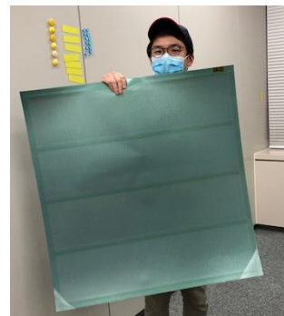
加飾フィルムを F-WAVE が量産する軽量フレキシブル太陽電池に実装した状態 木目調加飾フィルム（左）と単色フィルム（右）を貼り付けた加飾太陽電池
